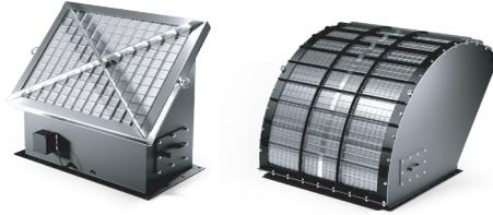
FLEX F PRO 및 FLEX R PRO는 화염, 압력, 열기의 전파를 효과적으로 차단하는 동시에 폭발 압력을 최저 수준까지 억제합니다. 이 보호 장치는 건물 내부에 설치된 컨베이어나 인원 이동이 빈번한 구역 등 폭연 방출구(VENT PRO)를 적용하기 어려운 환경에서 사용됩니다.
